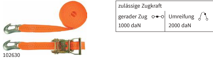
102630 Verzurrgurte BSN 2-teilig, Polyesterband, mit Ratsche, DIN EN 12 195-2, System 1000 daN, 35 mm
