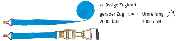
Verzurrgurte BSN 2-teilig, Polyesterband, mit Umkehrratsche. Gespannt wird beim „Nach-unten-ziehen“. DIN EN 12 195-2
