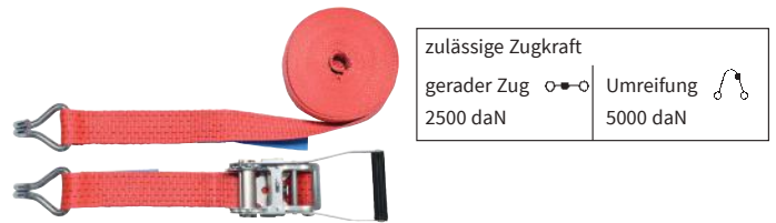
Verzurrgurte BSN 2-teilig, mit Ratsche, DIN EN 12 195-2, System 2500daN, 50 mm. Höhere zulässige Zugkraft als bei Standard-Verzurrgurte
