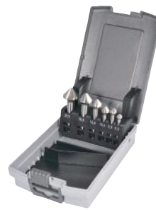
Kegelsenker-Satz HSS/CBN-geschliffen DIN 335, 3-schneidig 90° mit zylindrischem Schaft, axial und radial hinterschleifen, Form C, Spitzenfabrikat in Kusto-Kassette
