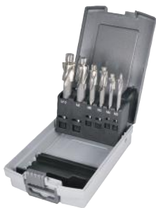
Flachsenker-Satz DIN 373 HSS mit Zylinderschaft und festem Führungszapfen, rechtsschneidend, Gütegrad mittel für Durchgangsloch in Kusto-Kassette
