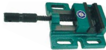
Bohrmaschinen-Schraubstöscke bewegliche Backe seitlich geführt, Prismenbacke gehärtet, geschliffen und brüniert
