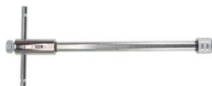
Werkzeugnarre langes Modell für Rechts- und Linkslauf, Stahl verchromt
